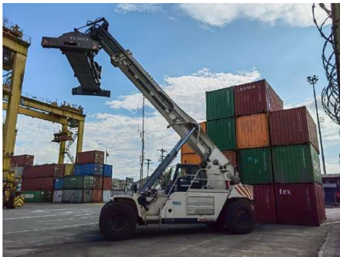
Figura 6. En el frente, se encuentra la máquina Reach Stacker y en el fondo, las grúas RTG
